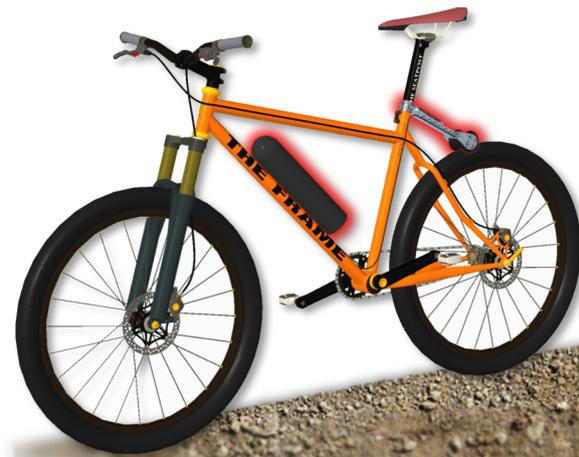
Ein mehrteiliges Antriebssystem soll konstruiert werden, welches durch zwei Adapter als E-Bike-Nachrüstset und als Antrieb für Stand-Up-Paddle-Boards und kleinere Boote genutzt werden kann. Die Adapter sollen mittels wasserdichtem Schnellspannsystem an einen Basisteil angeschlossen werden. Die Bedienung ist mittels Funkfernbedienung vorgesehen.
