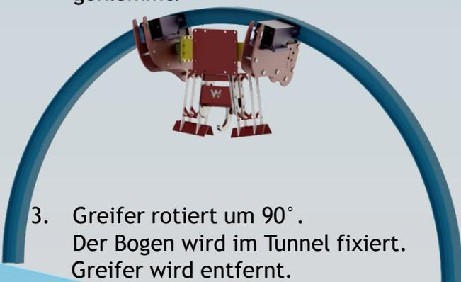
3. Greifer rotiert um 90°. Der Bogen wird im Tunnel fixiert. Greifer wird entfernt.
